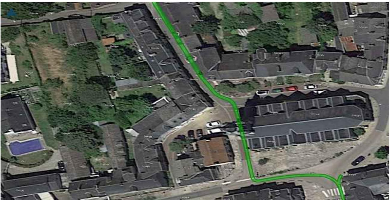
Une circulation cycliste monodirectionnelle, franchit, avec un marquage au sol et une signalisation adaptée, la voirie de la rue de la Mairie au niveau du carrefour pour tourner vers la gauche dans la Grand-Rue sur une vingtaine de mètres, puis tourne à droite en direction de la rue Pasteur. Le tronçon de voirie passant devant l'entrée de l'église vers la Grand-Rue devient interdit aux véhicules automobiles dont le trafic s'écoulera par la ruelle qui contourne le
